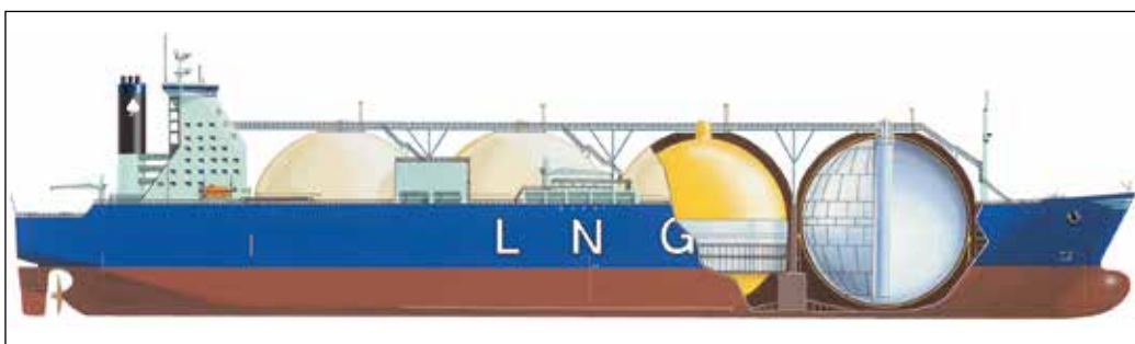
Seitenansicht eines LNG-Carriers mit Kugeltanks und einer Kapazität von ca. 150.000 m 3
