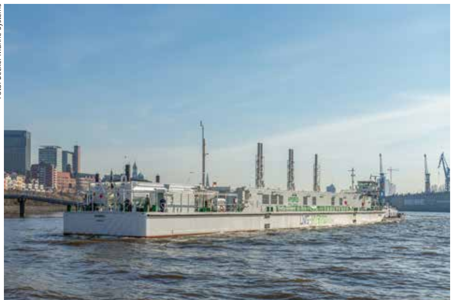
Mit der LNG-Hybrid-Barge „Hummel“ können Kreuzfahrtschiffe im Hamburger Hafen umweltfreundlich mit Strom versorgt werden
