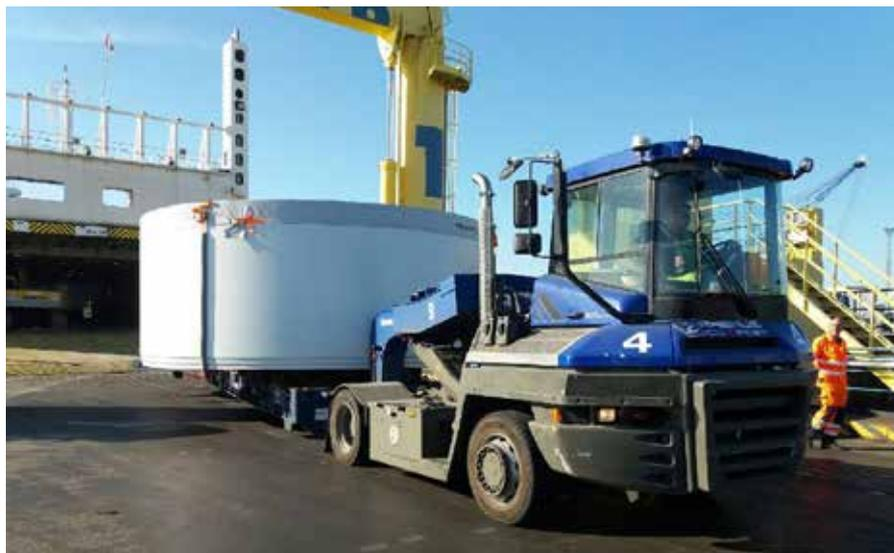
Über die RoRo-Rampe werden Offshore-Komponenten auf die Schiffe verladen
